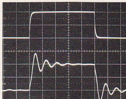
Foto 10: risposta all'onda quadra su carico resistivo (in alto) e su carico misto (in basso)
