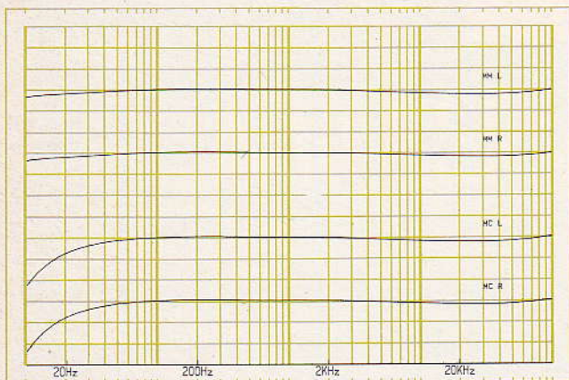
Fig. 1: risposta decodificata RIAA degli ingressi Phono (1 dB/div)
